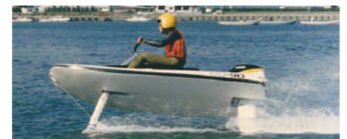
●図5 ボードタイプのシンプル水中翼船 OU90
