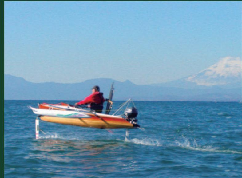
2013(平成25)年 開発した2馬力 20.6ノット(38km/h)の水中翼船
