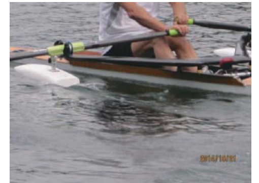
●図10 滑走型のフロートを開発(抵抗は約1/10に減)
