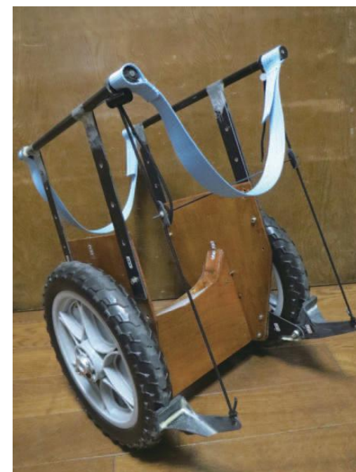
●図16 艇の重みでブレーキが掛かる機構付
