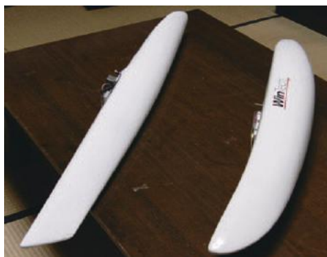
●図9 左：改良した半排水量型 右：現用型
