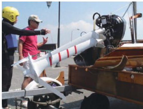
●図23 長く延ばした高速用船外機の脚
