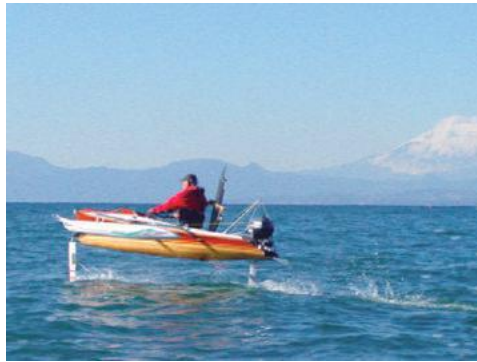
●図22 水中翼を付けて2馬力で20.6ノット(38km/h)を記録した
